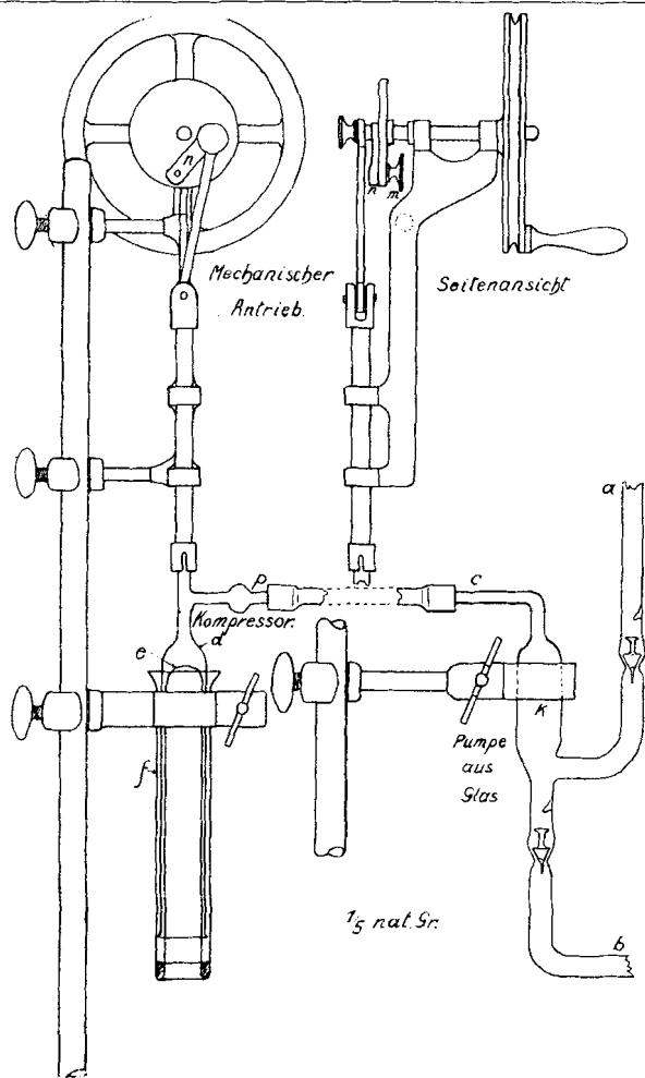
gesetzt wird. Die Ganghöhe des Kompressors ist so zu regulieren (s. unten), daß die Flüssigkeit beim Pumpen nicht über drei Viertel der Erweiterung  $k$  der Pumpe steigt, wodurch erreicht wird, daß die zu pumpende Flüssigkeit nur mit Glas in Berührung kommt.
